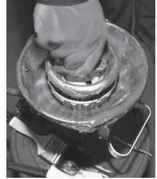
Şekil 22. Mekanik gres tabancası.
